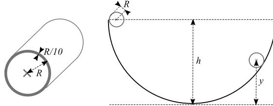
**Řešení:** Využijeme zákona zachování energie. Na začátku i v bodě obratu má válec nenulovou pouze potenciální energii  $E_p = mgh$ . Jeho kinetická energie z translačního a rotačního pohybu je
