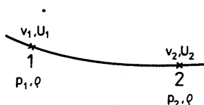
Obr. 10.7 Dvě místa na proudnici, pro něž hodnoty Bernoulliho výrazu (určující parametry jsou vyznačeny) mají stejnou hodnotu
